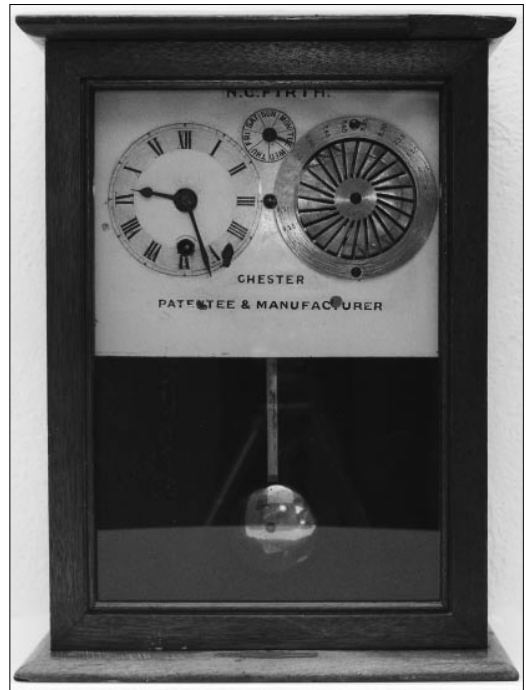
Abb. 1 Markenapparat von Firth (Oberteil). Die Fächerscheibe (rechts) wird vom Uhrwerk (links) ausgelöst und läßt zu bestimmten Zeiten eine Blechmarke mit aufgedruckter Uhrzeit in den Schacht fallen. Vorne ist der Einwurfschlitz für die Blechmarken der Arbeiter.
