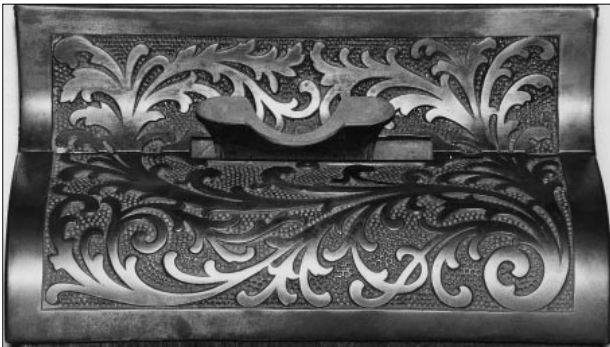
Abb. 13 Kartenapparat Rochester. Unterer Bereich mit reichlich verzierten massiven Gussteilen zur Führung des Kartentrichters. Dieser Bereich wird wegen seines Erscheinungsbildes bei den Amerikanern oft als »Wasserfall« bezeichnet.
