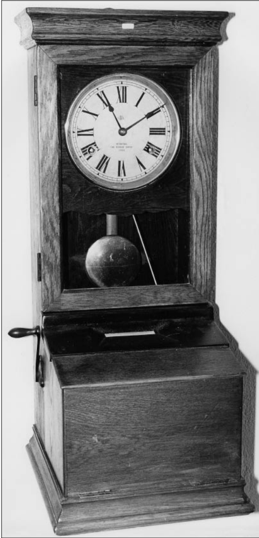
Abb. 2 Einschreibapparat von ITR. Der Stempelhebel auf der linken Seite gibt den Papierausschnitt zum Eintragen des Namens frei.
