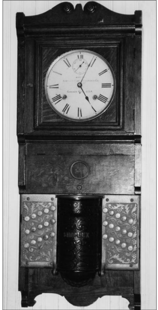
Abb. 9 Simplex-Apparat für 30 Beschäftigte, Modell 0. Dieses Modell wurde von 1894 bis 1904 hergestellt. Zwischen den Tastenreihen sitzt die Registriertrommel.
