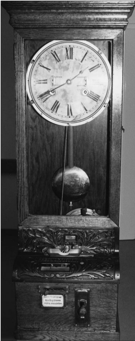
Abb. 14 ITR-Kartenapparat. Nachfolger des »Rochester« ab ca. 1912. Das Gehäuse ist bereits wesentlich schlichter, der »Wasserfall« ist noch verziert.
